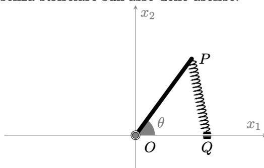
Utilizzando l'ascissa  $q$  di  $Q$  e l'angolo  $\theta$  che l'asta forma con l'asse orizzontale (indicato in figura) come parametri lagrangiani, si risponda alle seguenti domande.
