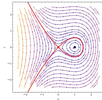
**A3** La separatrice corrisponde alle orbite nel piano delle fasi passanti per il punto di equilibrio instabile, ovvero ottenute per  $E = V(x_0) = 0$ . Nello spazio delle fasi  $(x, y)$  questa è data dall'equazione
