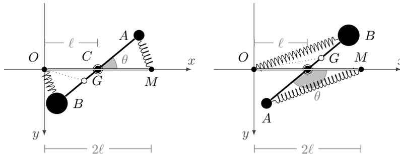
Nel limite  $k \rightarrow 0^+$ , le due molle sono assenti. Le due configurazioni di equilibrio trovate corrispondono a  $\theta_{\pm} = \pm \frac{\pi}{2}$ , ovvero le due masse sono in verticale: nella configurazione stabile, la massa più pesante è in basso. Nel limite  $k \rightarrow 0^+$ ,  $q$  può essere qualsivoglia nell'intervallo  $[0, 2\ell]$ , dato che l'equazione per esso  $\frac{\partial U}{\partial q} = 0$  è sempre soddisfatta
